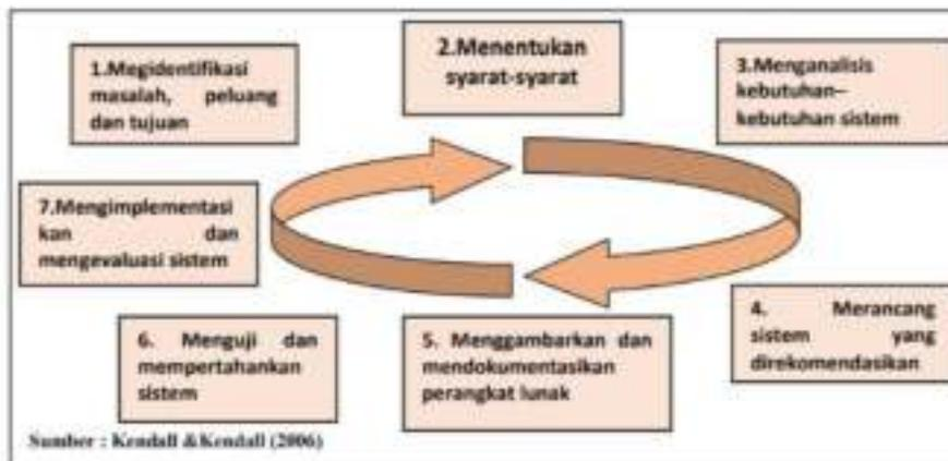
Berdasarkan gambar dari tahapan SDLC (*System Development Life Cycle*) dapat dijelaskan masing-masing tahapan sebagai berikut:
